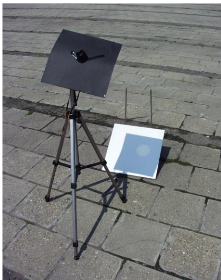
25. ábra: A Nap képe kivetítve távcső használatával.
