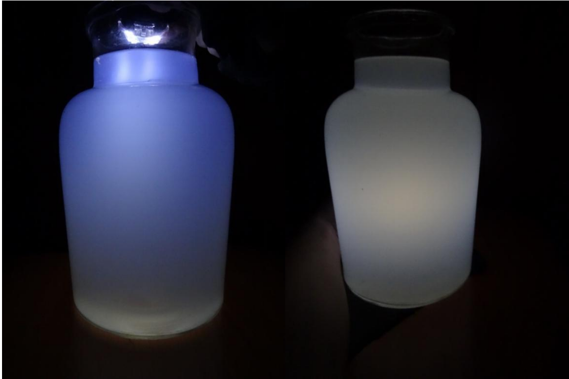
45. ábra: A fény szóródása tejjel „szennyezett” vízben.
