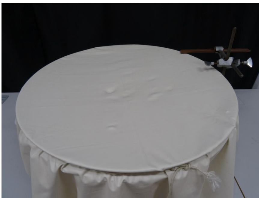
1. ábra: Az SZTE Kísérleti Fizikai Tanszékén használt eszköz: kerékpár abroncsra feszített gumilepedő, „indító” szerkezettel.
