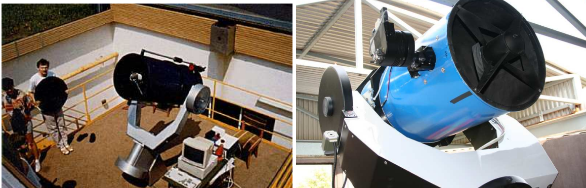
16. ábra. A Bajai Observatórium 50 cm átmérőjű Ritchey–Chrétien távcsöve (balra) és a Szegedi Csillagvizsgáló felújított 40 cm átmérőjű Newton távcsöve (jobbra).
