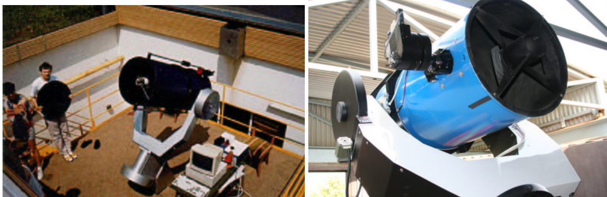
11. ábra. A Bajai Obszervatórium 50 cm átmérőjű Ritchey–Chrétien távcsöve (balra) és a Szegedi Csillagvizsgáló felújított 40 cm átmérőjű Newton távcsöve (jobbra).
